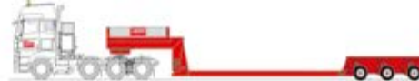
4+3 Achs Tiefbett / Kesselbett teleskopierbar und verbreiterbar 7,9m Grundbett + 5,9m teleskopierbar Verlängerungsträger 2m und 4m Nutzlast: 37t0
