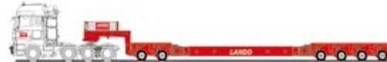
4+2+4 Achs hydr. Kesselbett 7,0m Grundbett + 4,0m teleskopierbar und hydr. verbreiterbar Verlängerungsträger 8m und 4m Nutzlast: 58t0
